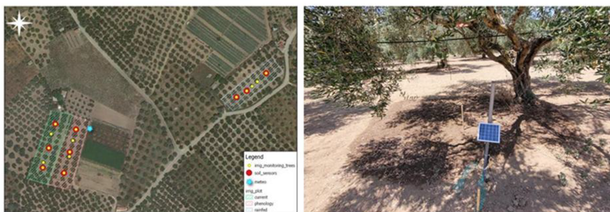
Εικόνα 2.2.3: Πειραματική διάταξη του δικτύου παρακολούθησης άρδευσης (αριστερά) και εικόνα αισθητήρα υγρασίας εδάφους (δεξιά) (Πηγή: Pantazis et al., 2025).
